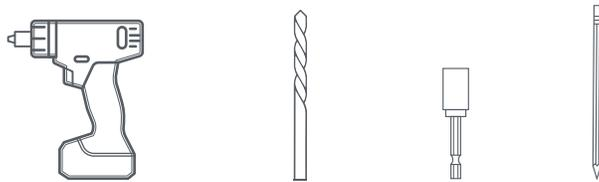
Bohrer/Schlagschrauber    6-mm-Bohrer-Bit (1/4 Zoll)    Steckschlüsseinsatz 10 mm    Bleistift
