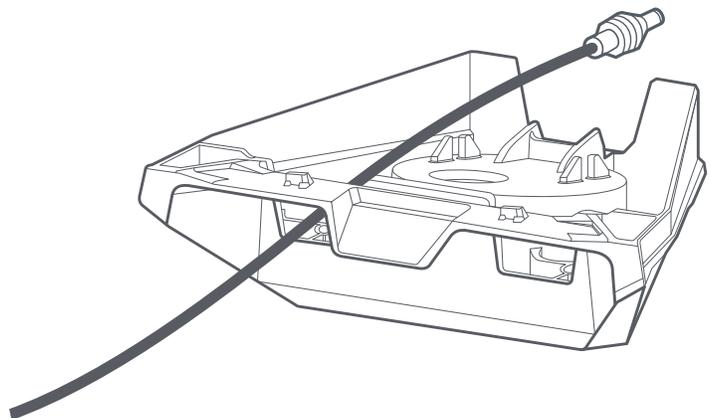
**PEMASANGAN DUDUKAN FLAT****5 | Sambungkan Kabel dan Pasang Starlink**
