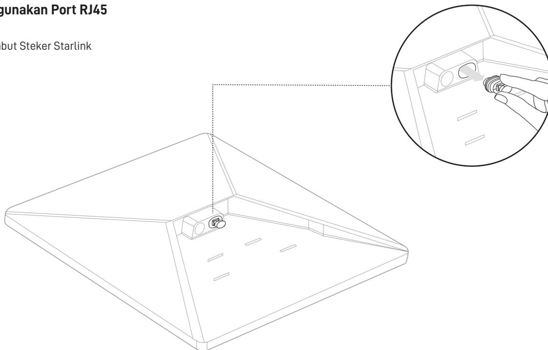
2. Sambungkan Kabel Starlink Mini yang tersedia di [shop.starlink.com](https://shop.starlink.com) atau kabel ethernet Anda sendiri ke port. Sambungkan ujung lain kabel Anda ke jaringan wired mesh atau perangkat keras pihak ketiga.
